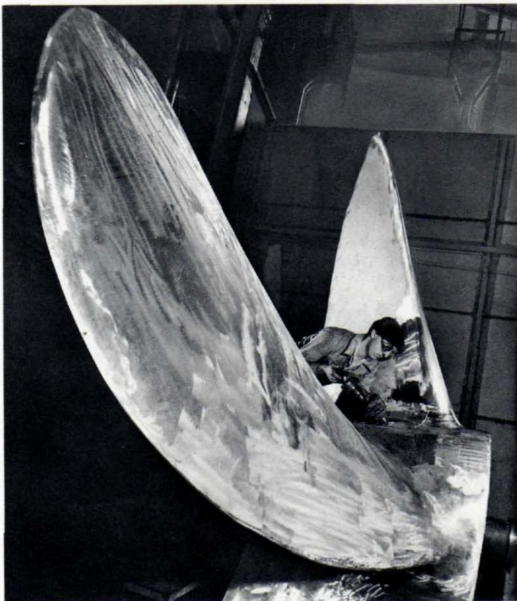
Burinage d'une hélice.
